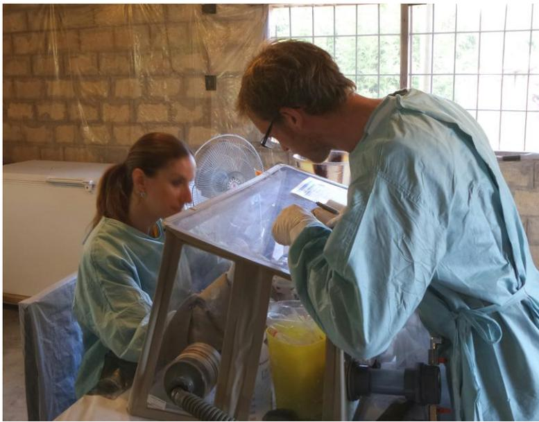
Una simple cabina sustituye las medidas de contención del laboratorio P3 en el que se trabaja en Europa.
