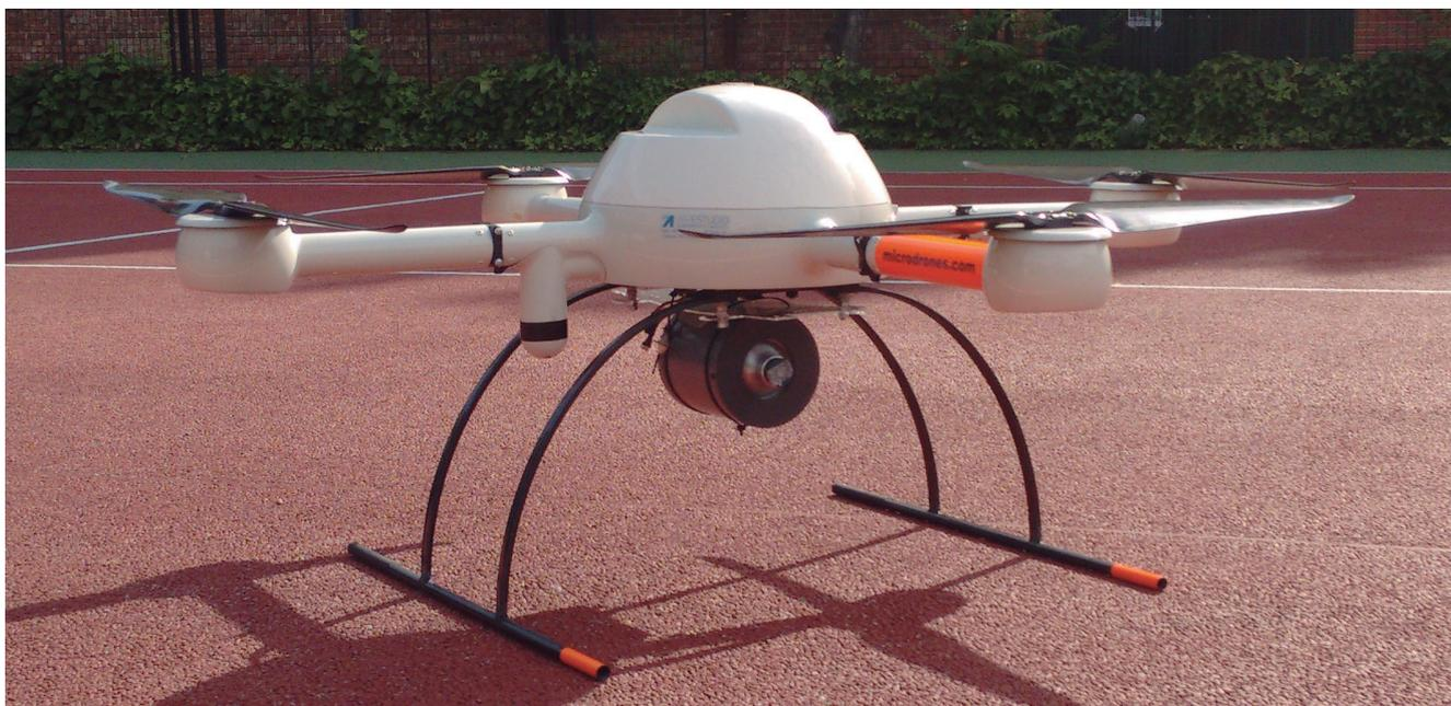
Figura 1. Captador de partículas diseñado por el grupo BIO-MAT, acoplado a un dron.
