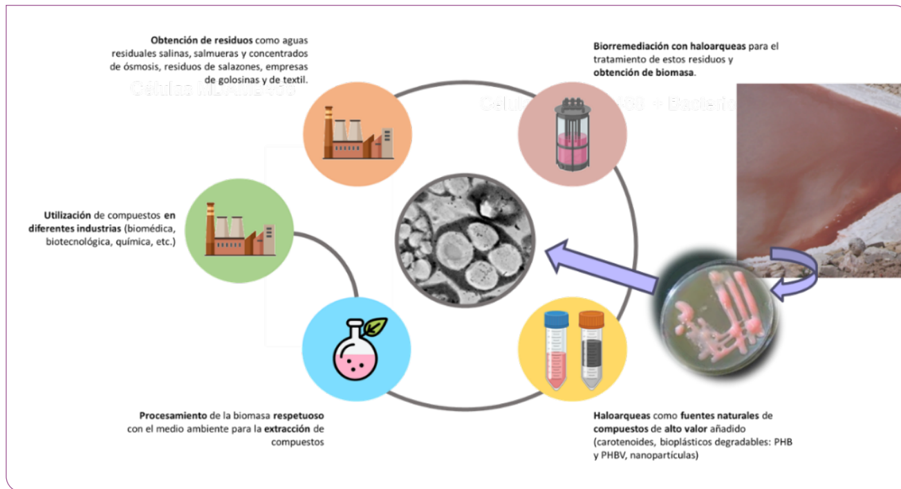
Figura 2. Esquema resumen del proceso de economía circular diseñado y desarrollado a escala laboratorio y prepiloto.
