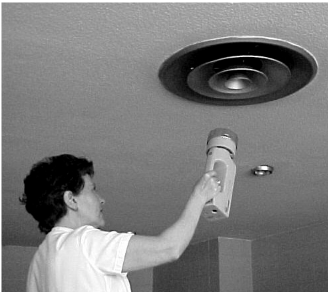
Figura 1. Tomas de muestras con aspirador bajo la rejilla de entrada de aire.
