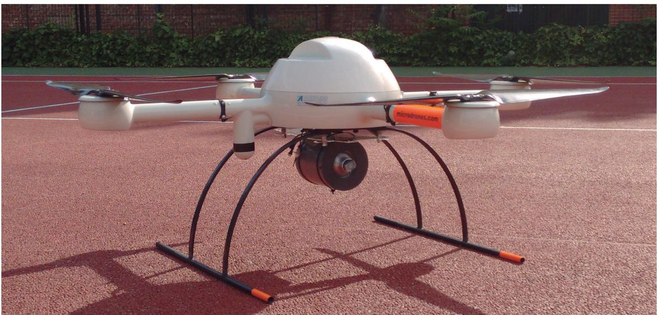
Figura 1. Captador de partículas diseñado por el grupo BIO-MAT, acoplado a un dron.
