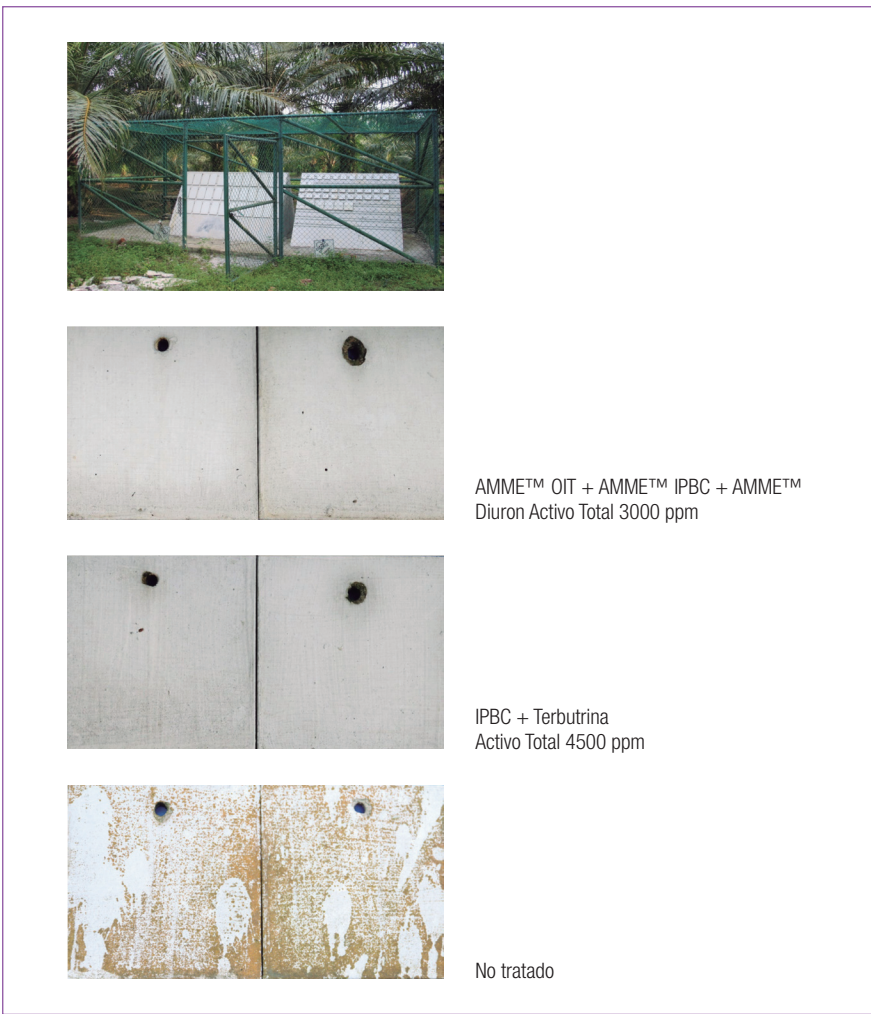
Figura 2. Paneles en el oeste de Malasia tras 24 meses de exposición
