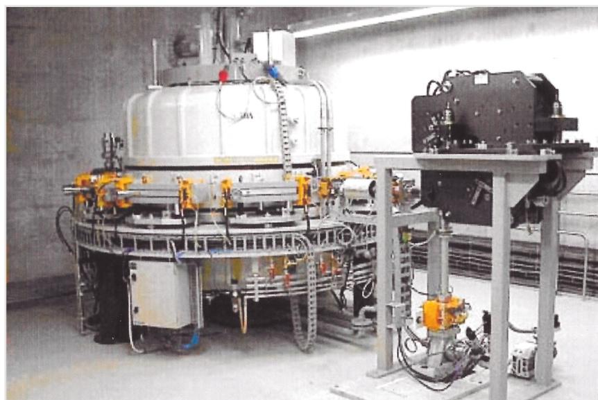
Figura 3. Acelerador de electrones Rhodotron TT200. Fuente: <http://almadeherrero.blogspot.com/2012/09/ionisos-iberica.html> (consultado 14/03/2022).
